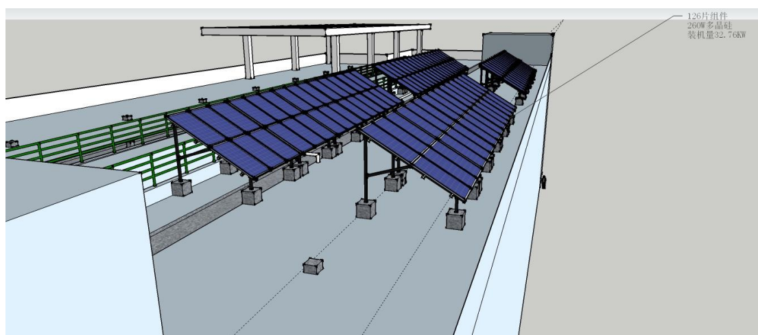
安装光伏系统侧视图（光伏电池板设计朝南 29 度倾斜角，武汉地区最优）
